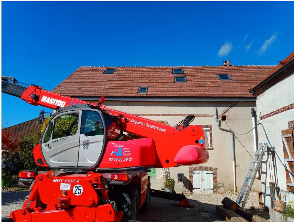
MRT 2540 portée de 25,40 m + Nacelle + flèche avec treuil de 2 x 25 m + godet + lève palette
