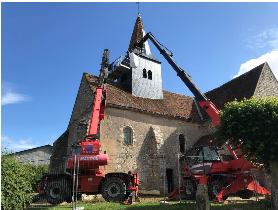
MRT 1840 portée de 18 m Nacelle + flèche avec treuil de 2 x 25 m + godet + lève palette
