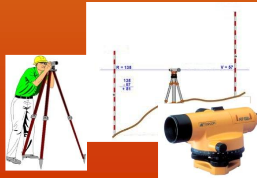
Implanter en altimétrie un ouvrage
